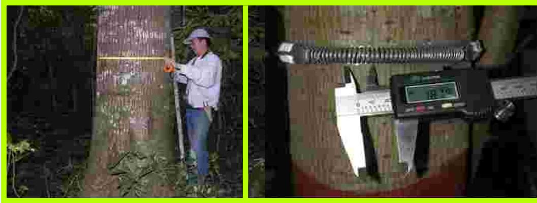
Figura 3. Medición del diámetro con cinta diamétrica y medición del crecimiento con calibrador de alta precisión en los árboles
