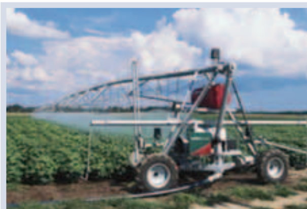
Figura 5.17. Sistema de avance frontal con mangueras.
