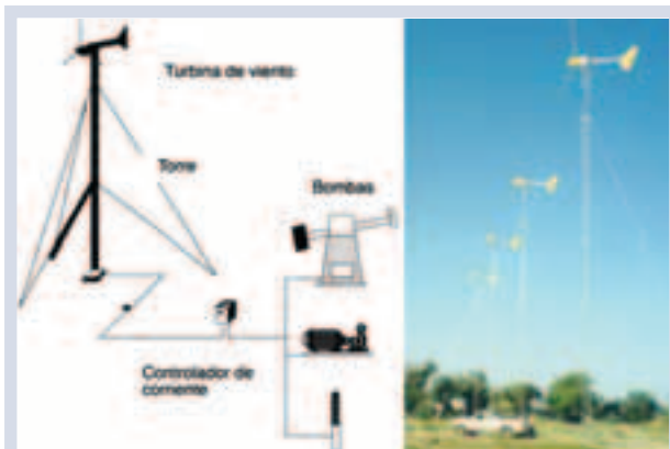
Figura 5.12. Sistema eléctrico de bombeo por viento.
