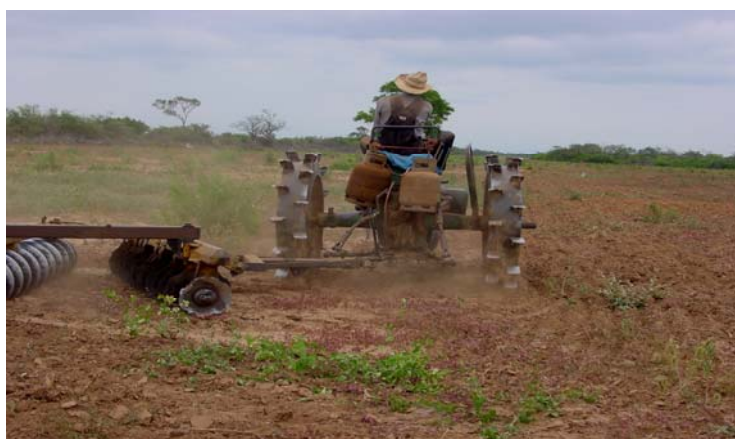
Figura 5.6.3 Tractor agrícola utilizando gas licuado como combustible
