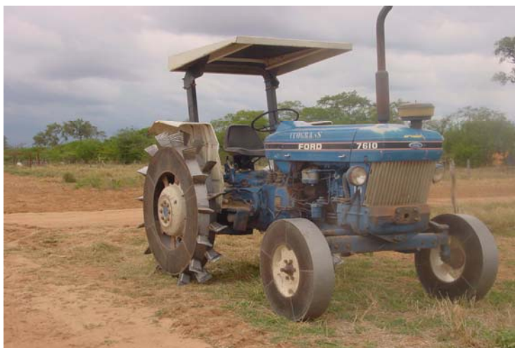
Figura 5.6.1 Tractor agrícola equipado con ruedas metálicas
